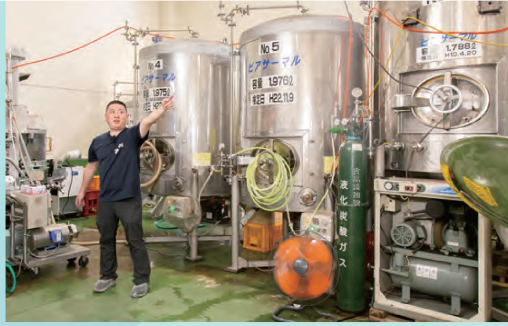
クラフトビールのタンクは煮沸と発酵で計10基。醸造から瓶詰めまでを一貫しておこないます。
