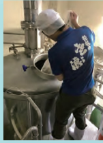
クラフトビールのタンクは煮沸と発酵で計10基。醸造から瓶詰めまでを一貫しておこないます。
